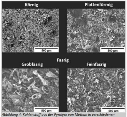
Abbildung 4: Kohlenstoff aus der Pyrolyse von Methan in verschiedenen flüssigen Metallbädern: Bi-Ni-Legierung (oben links), Ni-In-Legierung (oben rechts), Sn-Ni-Legierung (unten links) sowie Cu-In-Legierung (unten rechts)
